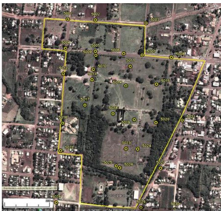
Figura 5 – Distribuição dos pontos de apoio do aerolevanteamento
