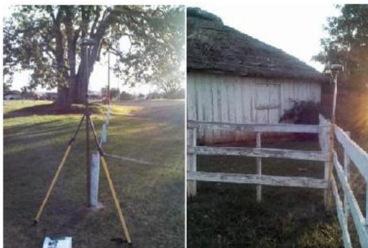
Figura 10 - Levantamento dos pontos de checagem
