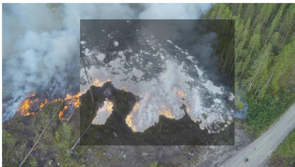
Figura 7. Imagem Termal sobreposta a uma imagem RGB obtidas com *drone* em uma área com ocorrência de incêndio florestal. Fonte: *Forest Data Lab*, 2016.
