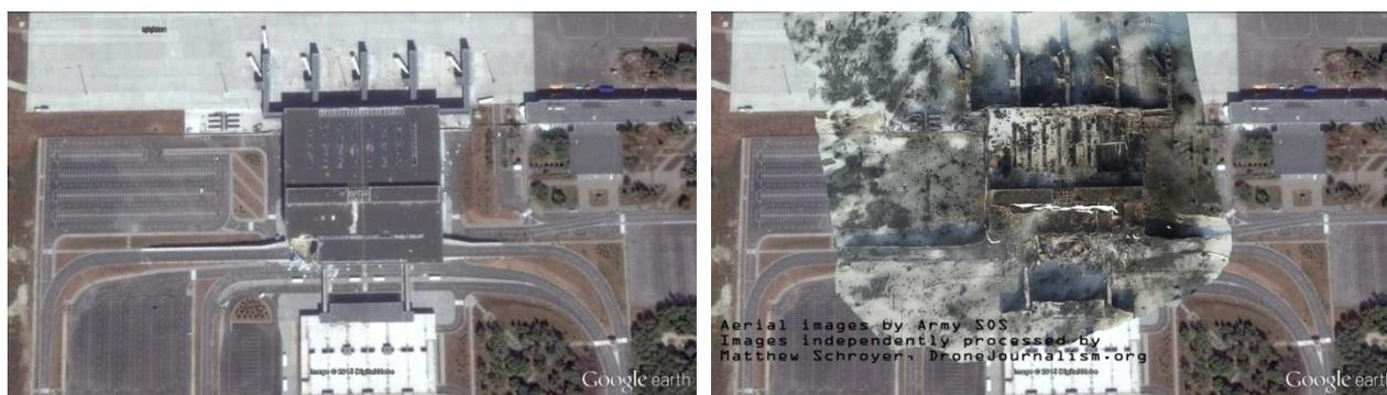
Figura 10 (Izquierda): Imagen satelital de la estación principal del aeropuerto de Donetsk antes del conflicto bélico. Fuente: *Google Earth*, 2014. (Derecha): Misma imagen satelital del aeropuerto de Donetsk solo que esta se destaca por presentar una superposición digital realizada en 3D mediante técnica de fotogrametría a partir del uso de *drones* y *software Photoscam* para comparar el estado del aeropuerto al finalizar la guerra. Fuente: *Army SOS aerial video* y M. Schroyer, 2015.
